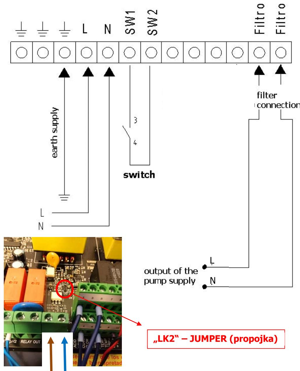
**3.3.2.2. START/STOP – napěťové propojení s recirkulačním čerpadlem v kombinaci se senzorem zavzdoušnění nebo s průtokovou klapkou**
