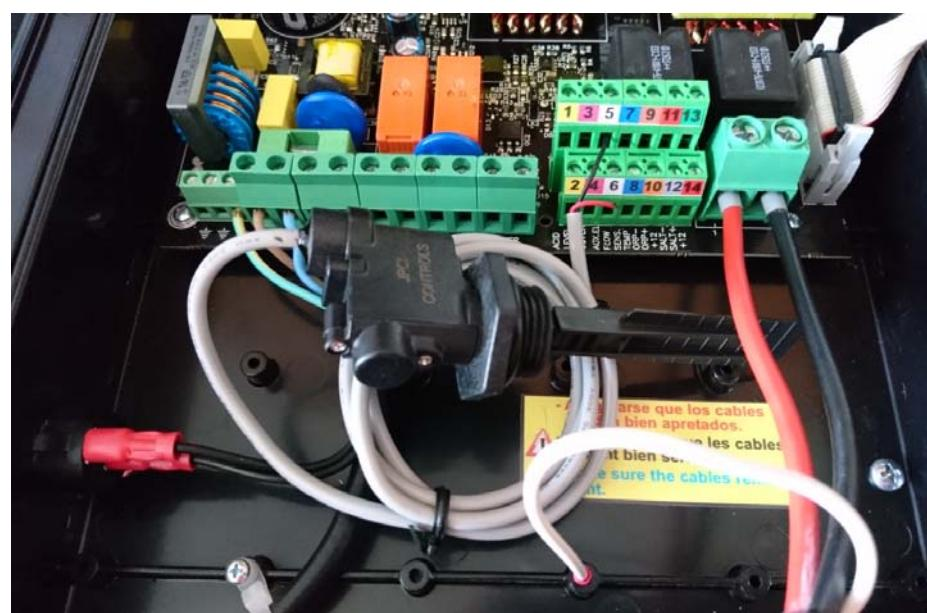
J4: Připojení cely (nezáleží na polaritě / automat. čištění = změna polarity)
